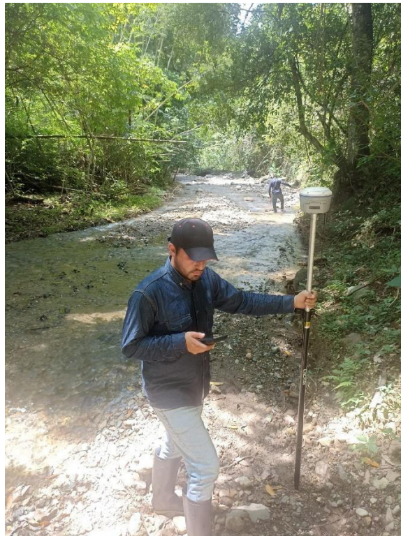
Ilustración 9 Toma de datos con GNSS ROVER, Autor.
